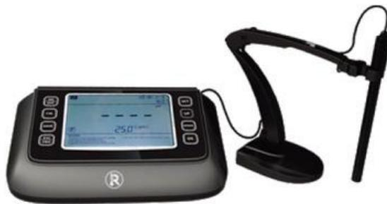
Tela LCD de 6,5 polegadas que é intuitiva e pode mostrar mais parâmetros. O design da interface operacional torna as operações mais simples. O painel de toque leve e duradouro pode ser usado mais de 100.000 vezes. Calibração automática, compensação automática de temperatura, armazenamento de dados, exportação de dados USB, relógio, impressão sem fio, configuração de funções, autodiagnóstico inteligente e outras funções inteligentes.
